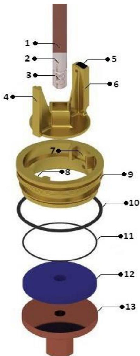
Une fois toutes les pièces assemblées, vous êtes prêt à remonter le mécanisme inférieur
